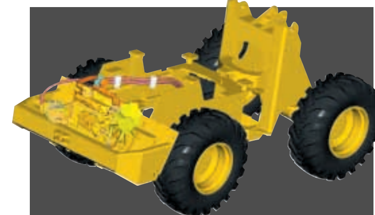
抜群の車両安定性を実現するエンジン横置きレイアウト
