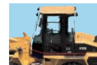
労働安全衛生法に基づく ヘッドガード基準をクリアするキャブ
